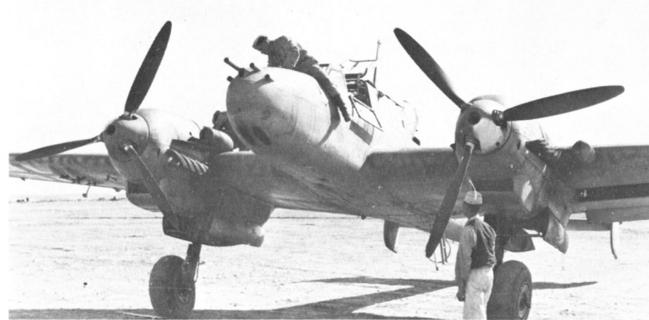
Im Frühjahr und Sommer 1942 traf der Zerstörer Bf 110 F-2 auf den Kriegsschauplätzen in Nordafrika ein. Die erhöhte Motorleistung der F-Modelle war sehr willkommen, da sie den Auftrag hatte, Rommels Vormarsch nach El Alamein zu unterstützen. Dieser Bf 110 F-2 Zerstörer, der zum ZG 26 gehört, ist mit Wüsten-Staubfiltern und zwei ETC 50 Bombenaufhängevorrichtungen unter jeder Tragfläche ausgerüstet.
