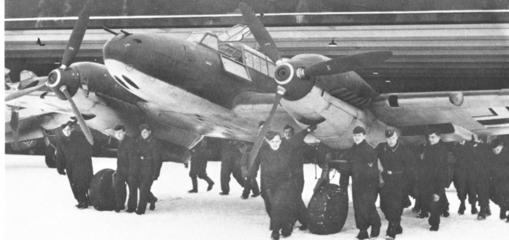
Die ersten Maschinen der Serie Bf 110 C-1 wurden im Januar 1939 an die I.(Z)/LG 1 in Greifswald ausgeliefert. Das C-1 Modell besaß serienmäßig den neuen UDM dreiflügligen voll verstellbaren Propeller.
