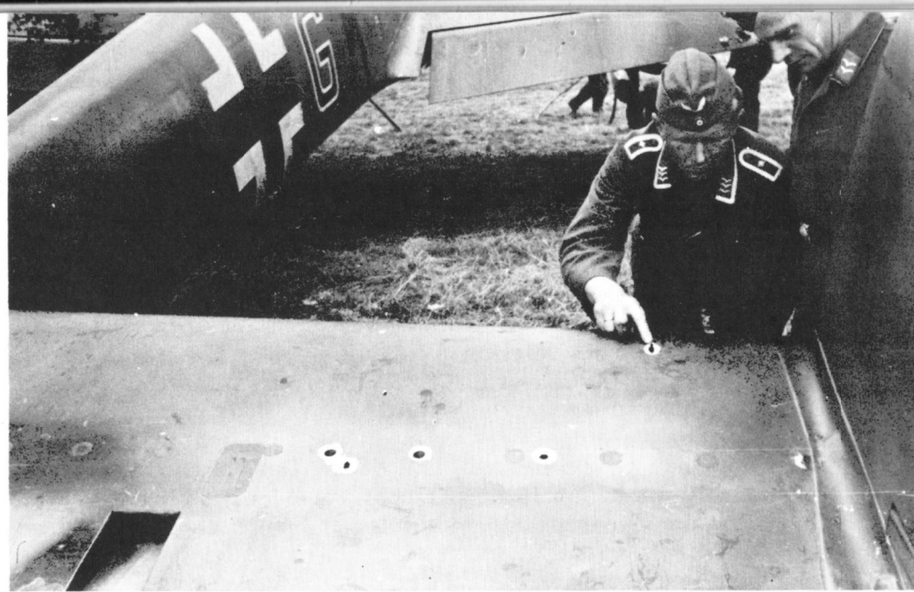
Diese Zellen-Mechaniker überprüfen die Heckpartie eines Flugzeuges, nachdem es vom Flakfeuer getroffen worden ist. Erst kürzlich reparierte Einschußstellen kann man am Leitwerk sehen. Einschüsse wie diese verursachten gewöhnlich wenige Probleme. Sie waren meistens innerhalb einer Stunde repariert.
