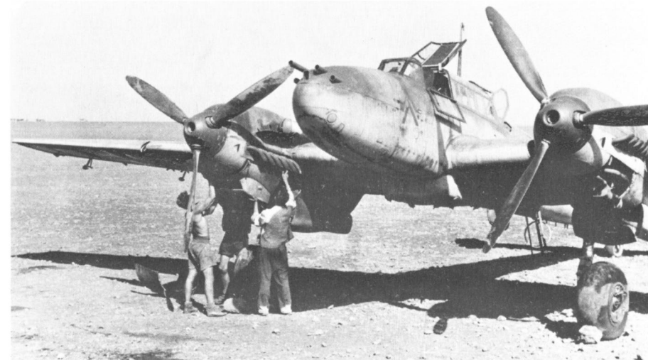
Diese Bf 110 F-1 Jagdbomberversion war mit zwei ETC 500 Bombenaufhängevorrichtungen neben dem Flugzeugrumpf ausgerüstet. Sie konnte dort zwei 250 kg SC 500 Sprengbomben oder SD 250 Splitterbomben, zwei 500 kg SC 500 Bomben oder einen Behälter AB 500, der seine kleinen Brand- und Splitterbomben durch einen Sprengsatz in der Luft freisetzte, unterbringen. Die offene Fläche des Geländes gibt einen Eindruck von den Einsatzbedingungen der deutschen Luftwaffe in Nordafrika.
